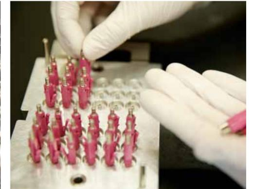
**2.** Die Stecker werden händisch auf einem Tablett einsortiert. Anschließend werden die Stecker durch den Kleberoboter mit Kleber befüllt.
