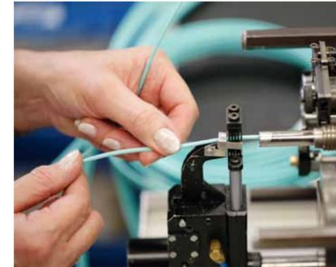
**1.** tde gewährt Einblicke in die Kabel-Konfektion: Als erstes werden Kabelmantel und Buffer abgemantelt und das Kevlar beige-schnitten. Die Absetzlängen unterscheiden sich je nach Stecker.
