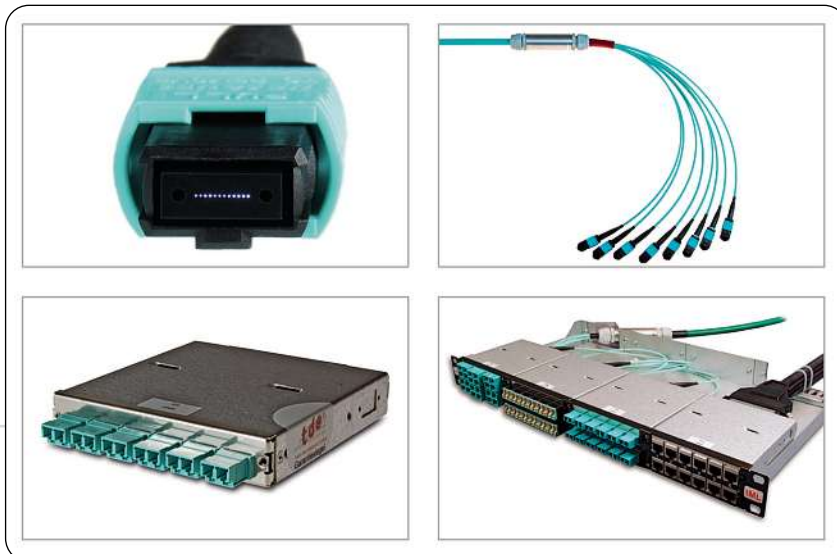
Bild 3: tML-Modulträger voll bestückt, 12-Fasern-MPO + MPO-Fanout-Kabel + LC-Modul mit sechs mal LC-Duplex und tML-Modulträger, voll bestückt
