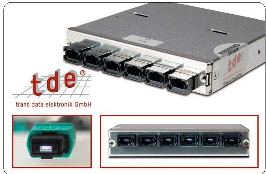
Bild 1: tML-72-Faser-Modul, 72-Faser-MPO-Modul, rückseitig ein 72-Faser-MPO, vorderseitig sechs Stück 12-Faser-MPOs
