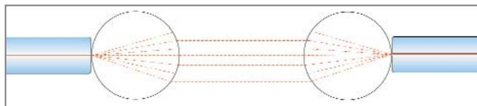
Bild 1: Der Linsenstecker basiert auf der Expanded-Beam-Technik
