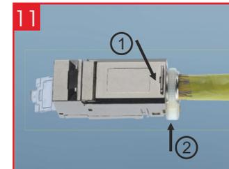
1 - Zugentlastungsschieber auf das Kabel drücken
