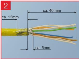
Schirmgeflecht über den Kabelmantel zurückziehen und mit Klebeband fixieren. Folienschirm auf 5mm kürzen.
