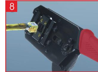
Das Kabel mit Kabelstecker in die Verpresszange einlegen. Kabelstecker ausschließlich mit Hilfe der Verpresszange (Art.Nr. TBL-KT-TOOL) crimpen
