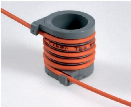
**Mandrel Wrap beseitigt die Moden höherer Ordnung bei Multimode-Dämpfungsmessungen unter Verwendung einer LED-Lichtquelle.**
