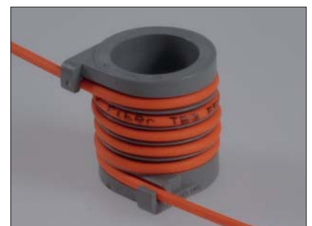
Bild 2: Mandrel Wrap beseitigt die Moden höherer Ordnung bei Multimode-Dämpfungsmessungen unter Verwendung einer Lichtquelle
