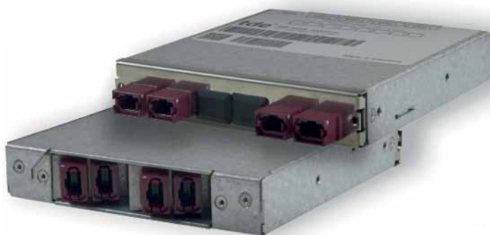
Das kompakte tML-LWL-Spine-Leaf-Mesh-Modul vereinfacht die Verkabelung in komplexen Spine-Leaf-Architekturen, indem es zwischen vier und 16 Kanäle/Faserpaare zusammenfasst und wieder aufteilt. Dies reduziert die Zahl der Anschlüsse um ein Viertel, Achtel oder Sechzehntel.
