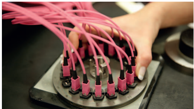
Bild 2. Das Polieren der Stecker ist absolute Präzisionsarbeit. Auf den Nanometer genau werden die Faserendflächen unter Einsatz von Diamant- oder Aluminiumoxidfolien auf Spezialmaschinen poliert.
