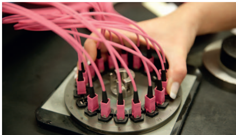
Bild 2. Das Polieren der Stecker ist absolute Präzisionsarbeit. Auf den Nanometer genau werden die Faserendflächen unter Einsatz von Diamant- oder Aluminiumoxidfolien auf Spezialmaschinen poliert.
