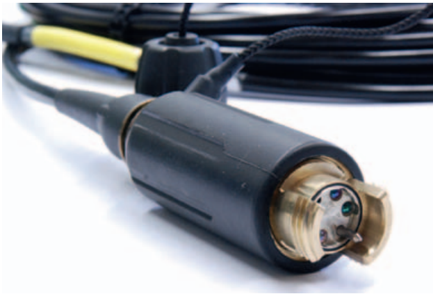
Bild 4. Besonders bei LWL-Steckverbindern sind die Steckzyklen zu beachten. Diese können bei Präzisionssteckern einige hundert Zyklen betragen, bei LWL-Steckern (links) liegen sie bei mindestens 500 – 1.000 und bei speziellen Linsensteckern (rechts) bei mehreren zehntausend.
