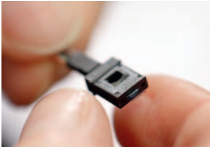
Bild 3. In hochpräziser Handarbeit werden die 12 oder 24 Faserenden in den MPO-Stecker eingeführt.
