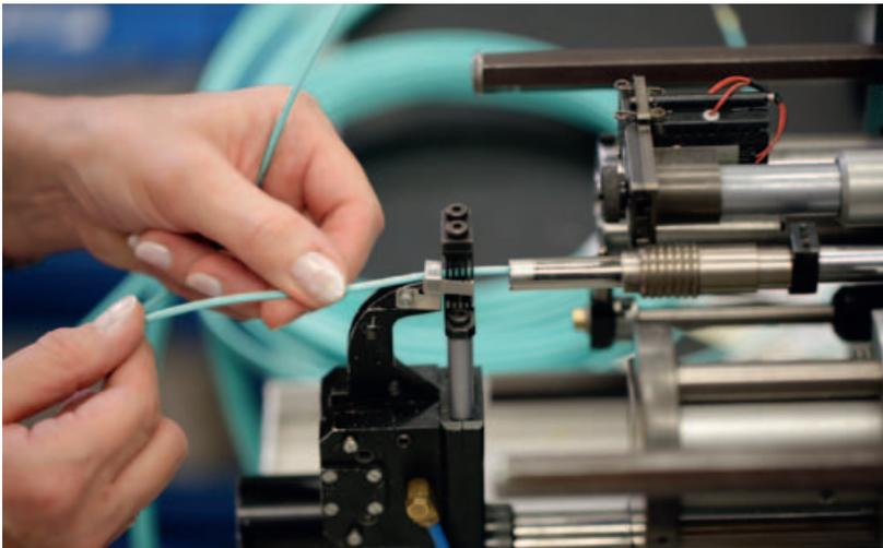
**Bild 1.** Höchste Präzision in allen Fertigungsschritten, wie hier beim sog. „Cable Preparing“ des Netzwerkherstellers tde – trans data elektronik. Vor der eigentlichen Steckerkonfektionierung erfolgt die maschinelle Vorbereitung des Kabelendes. Kabelmantel und Buffer werden abgemantelt und das Kevlar beigeschnitten.
