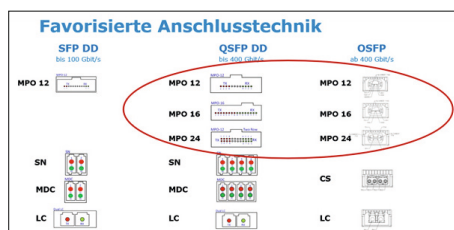
Bild 1. Zukunftsfähige und investitionssichere Migrationsoptionen bis 400G und darüber hinaus erhalten Anwender und Unternehmen nur mit der MPO-Anschlussstechnik. Bild: TDE
