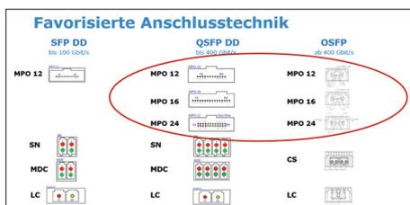
**Bild 1. Zukunftsfähige und investitionssichere Migrationsoptionen bis 400G und darüber hinaus erhalten Anwender und Unternehmen nur mit der MPO-Anschluss-technik.** Bild: TDE
