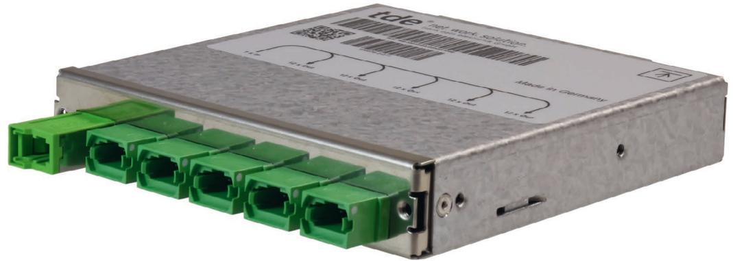
**Das tML-LWL-Splitter-Modul ermöglicht die Aufteilung eines E2000 APC-Steckverbinders auf fünf 12-Faser-MPOs. Im Modul ist demnach ein 1:60-Splitter integriert. Alternativ dazu bietet die tde ein Modul mit zwei 1:60-Splitttern, bei dem sich zwei E-2000 APC-Steckverbinder mit fünf 24-Faser-MPOs verbinden. In Kombination mit dem tML finden acht tML-LWL-Splittermodule auf 1 HE Platz**
