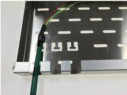
2. Für die Zugentlastung das Stammkabel an der Baugruppenträgerkabelabfangung mittels Kabelbinder befestigen.
