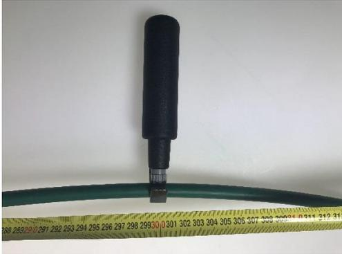
1. Stammkabel bei 300cm absetzen. An der Absetzstelle Kabel mit Schrumpfschlauch oder Gewebeklebeband versehen.
