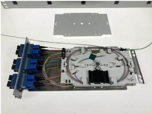
5. Bündelader ca. 90cm absetzen, mit Gewebeband an der Absetzstelle verstärken und anschließend in der Spleißkassette mittels Kabelbinder befestigen.
