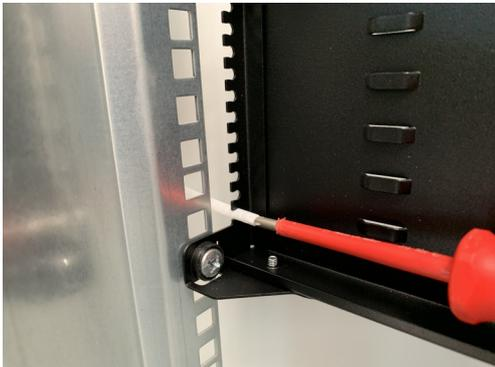
10. Durch das abschneiden, können Quetschungen am Flexschlauch entstehen. Diese können mittels eines Kreuzschlitz-Schraubendrehers oder ähnlichem Hilfsmittel wieder aufgeweitet werden.
