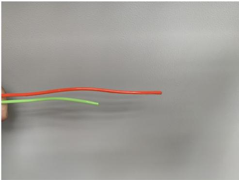
22. Eine der beiden Bündeladern ca. 2-3cm kürzer schneiden damit eine spätere Zuordnung der Fasern im Modul gewährleistet bleibt.
