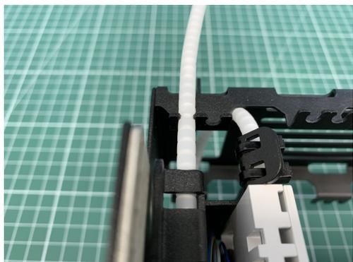
5. ... den Flexschlauch in die Aufnahme des tDF<sup>®</sup> - Bündeladermanagements drücken...
