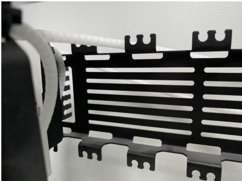
30.... dabei den Flexschlauch über die Backplane in Richtung Aufteileinheit führen.
