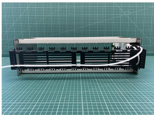
6. ...und dann unten an der Backplane in Richtung der Aufteileinheit führen.
