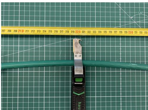
14. Stammkabel bei 220cm markieren und mit einem geeignetem Werkzeug den Kabelmantel absetzen.
