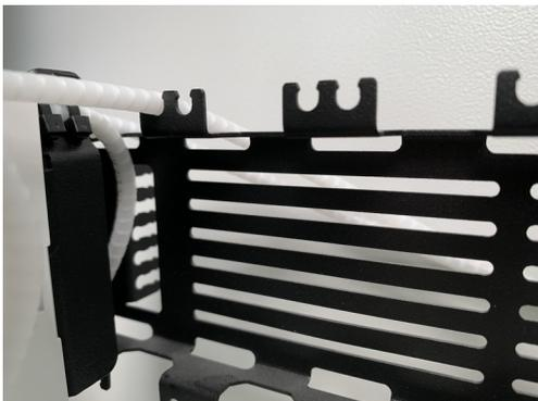
31. Flexschlauch in die obere Schlauchklemme drücken...
