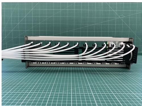
7. - Flexschlauch des tDF<sup>®</sup> - LWL Spleiß-zu-Patch Moduls von Slot 1 anfangen in der untersten Aufnahme zu verlegen und von Slot zu Slot sich bei den Aufnahmen hocharbeiten.
