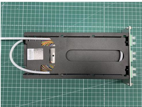
3. tDF<sup>®</sup> - LWL Spleiß-zu-Patch Modul umdrehen und Flexschlauch wie abgebildet bis zum Ende in das Überlängenfach einführen.
