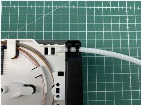
2. Deckel des tDF<sup>®</sup> - LWL Spleiß-zu-Patch Moduls öffnen und den Flexschlauch mittels zweier Kabelbinder in der V-Nut befestigen.
